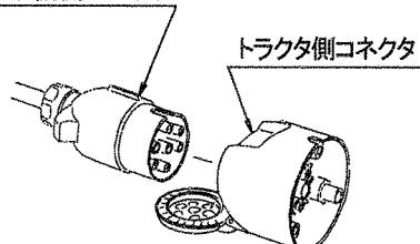
また、トラクタ側に外部電装品取り出し口が装備されていない場合は、別途トラクタ側コネクタの電気配線が必要となります。
