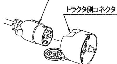
また、トラクタ側に外部電装品取り出し口が装備されていない場合は、別途トラクタ側コネクタの電気配線が必要となります。
