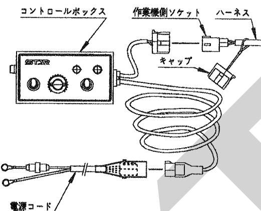
(1) 電源コードをバッテリターミナルへ取り付けてください。電源コードのターミナルは、トラクタのバッテリターミナルをとめているボルトと共に締めにしますのでバッテリから $\ominus$ 、 $\oplus$ 共にコードを外してください。コードを外す時は、 $\ominus$ 側から外してください。又、取り付ける時は、 $\oplus$ 側から取り付けてください。
