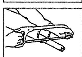
(4) 切り口をヤスリなどでなめらかに仕上げてからパイプをよく清掃し、次にグリースを塗布して、アウタとインナを組み合わせます。
