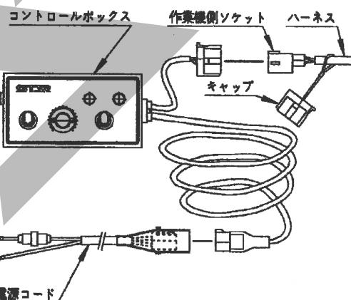
(1) 電源コードをバッテリターミナルへ取り付けてください。電源コードのターミナルは、トラクタのバッテリターミナルをとめているボルトと共に締めにしますのでバッテリから $\ominus$ 、 $\oplus$ 共にコードを外してください。コードを外す時は、 $\ominus$ 側から外してください。又、取り付ける時は、 $\oplus$ 側から取り付けてください。
