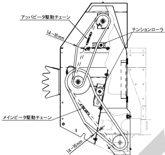
(4) ボルト・ナットを締め、テンションローラを固定してください。
