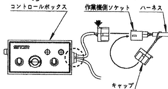
コントロールボックスから作業機側ソケットを外す時は、矢印部分を押しながらかき外してください。
