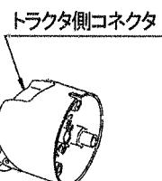
また、トラクタ側に外部電装品取り出し口が装備されていない場合は、別途トラクタ側コネクタの電気配線が必要となります。
