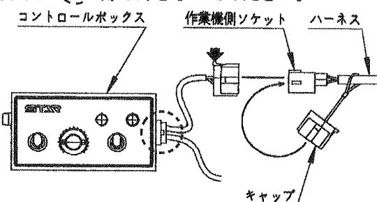
コントロールボックスから作業機側ソケットを外す時は、矢印部分を押しながら外してください。
