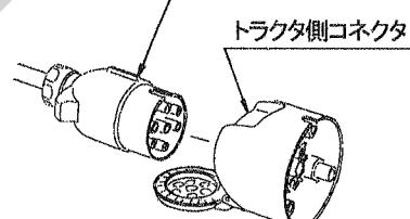
また、トラクタ側に外部電装品取り出し口が装備されていない場合は、別途トラクタ側コネクタの電気配線が必要となります。
