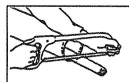
(4) 切り口をヤスリなどでなめらかに仕上げた後からパイプをよく清掃し、次にグリースを塗布して、アウタとインナを組み合わせます。
