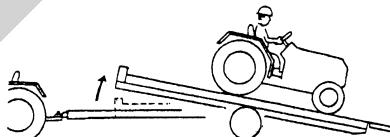
(9) アユミが地面についたら、再び、積載したトラクタやコンバインを動かし、トレーラから降ろしてください。
