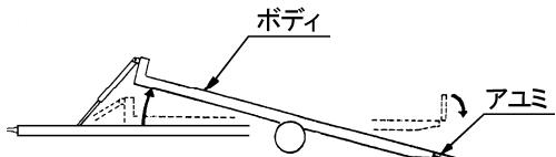
※ ボディ水平 : ボディを平にし、アユミを上げた状態で、運搬状態になります。
