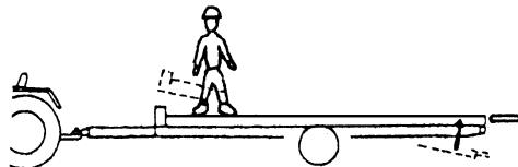
(13) ラッチpinでボディとドローバが固定されているを確認し、ラッチpinが抜けないようロックpinを差し、抜け止めにリンチpinを取り付けてください。
