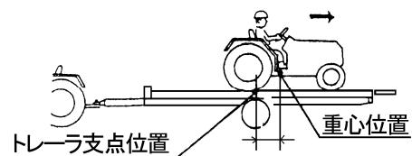
(8) 積載したトラクタやコンバインの重心位置がトレーラの荷台支点位置を越えると、ボディが傾斜しあります。
