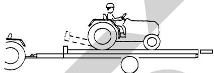
(11) 完全に水平になったら、10~20 cm ドローバー側に移動し停止してください。
