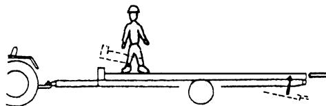
(13) ラッチpinでボディとドローバが固定されているを確認し、ラッチpinが抜けないようロックpinを差し、抜け止めにリンチpinを取り付けてください。
