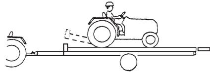
(11) 完全に水平になったら、10~20cmドロバ側に移動し停止してください。
