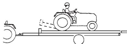
(11) 完全に水平になったら、10~20cmドロワー側に移動し停止してください。
