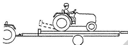
(12) 完全に水平になったら、10～20cmドローバ側に移動し停止してください。エンジンをとめ、駐車ブレーキをかけ、ギヤを1速に入れてください。
