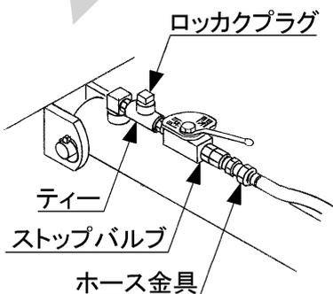
(4) 油差しでロックプラグを外したティーからオイルを注入し、油圧シリンダ内やホース内のエアを除去してください。
