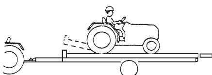
(12) 完全に水平になったら、10~20cmドローバ側に移動し停止してください。
