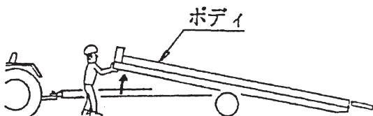
(7) ボディの傾斜が足りない場合、ボディの後方に乗りなどの補助をしてください。
