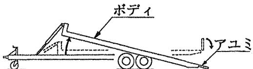
※ ボディ水平：ボディが水平になりはじめるのと連動してアユミが上がり、運搬状態になります。
