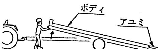
(6) ボディの傾斜が足りない場合、ボディの後方に乗るなどの補助をしてください。
