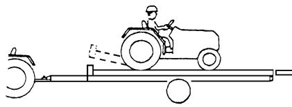
(11) 完全に水平になったら、10~20cmドローバー側に移動し、停止してください。
