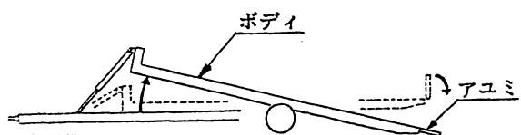
※ ボディ水平：ボディが水平になりはじめると運動してアユミが上がり、運搬状態になります。
