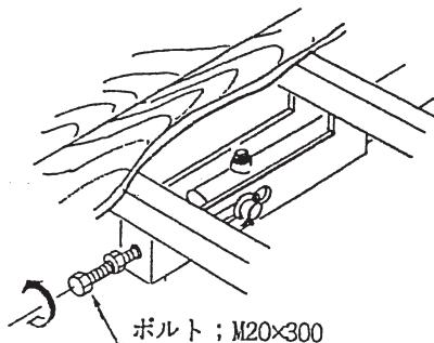
(2) アユミが降下しはじめますので所望の角度の位置にアジャストピンを入れ替え、抜け止めにベータピンを差してください。
