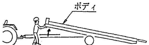
(7) ボディの傾斜が足りない場合、ボディの後方に乗るなどの補助をしてください。
