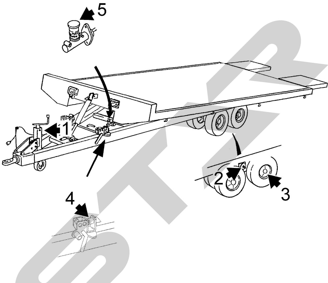
図は給脂箇所を示します。表に基づき給脂してください。
