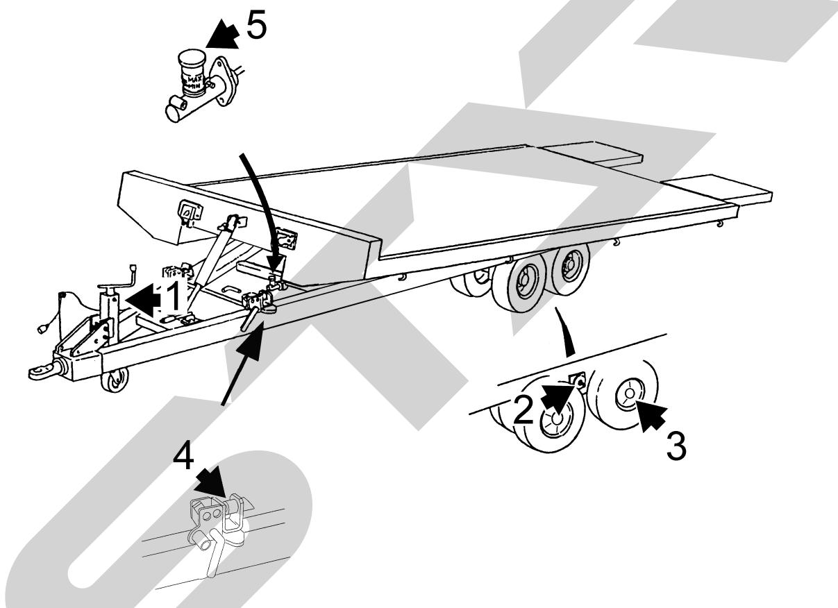
図は給脂箇所を示します。表に基づき給脂してください。
