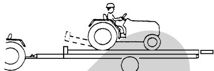
(12) 完全に水平になったら、10~20cmドローバ側に移動し停止してください。
