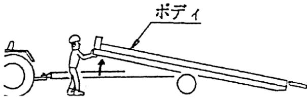
(7) ボディの傾斜が足りない場合、ボディの後方に乗るなどの補助をしてください。
