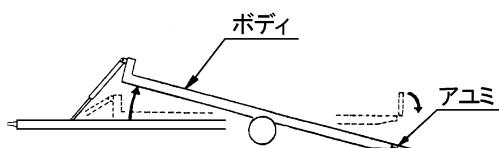
※ ボディ水平: ボディを平にし、アユミを上げた状態で、運搬状態になります。
