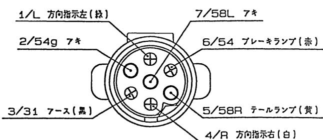
又、トラクタによっては、作業機の電装品を接続すると、リレーの容量が不足し、点灯しない時があります。
