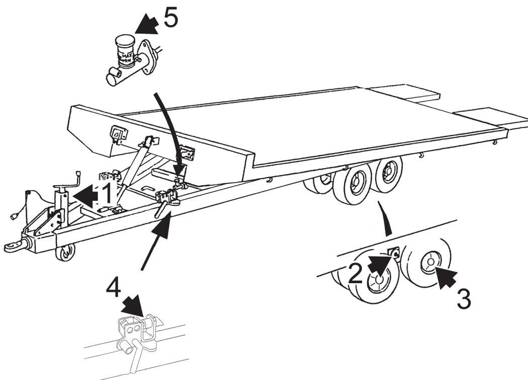
図は給脂箇所を示します。表に基づき給脂してください。
