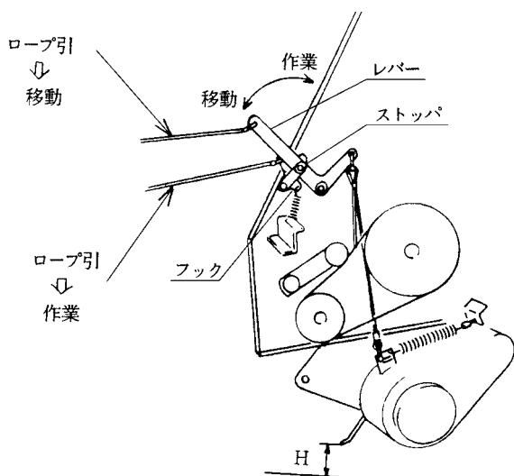
(2) ピックアップの移動状態・作業状態の切替えは、トラクタ座上よりロープを操作して行います。
