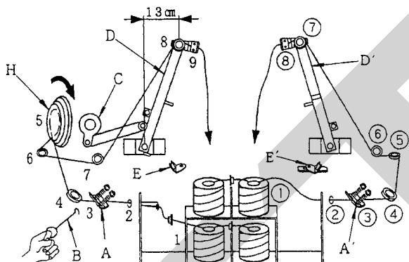
(5) 作業を始めるときは、必ずアームの位置を図示のようにC（アーム）を下方に向け、D・D'（アーム）がE・E'（ナイフ）上部の位置になるようにセットしてください。
