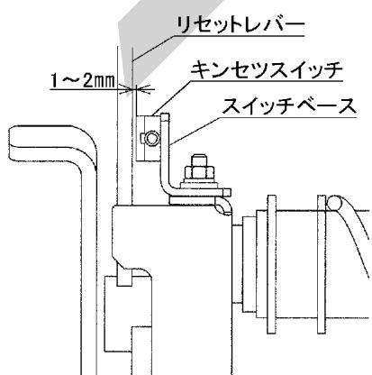
ネットバインディングのキンセツスイッチは、リセットレバーとのすき間を1~2mmに調整してください。調整はナイフリセット状態で行ってください。
