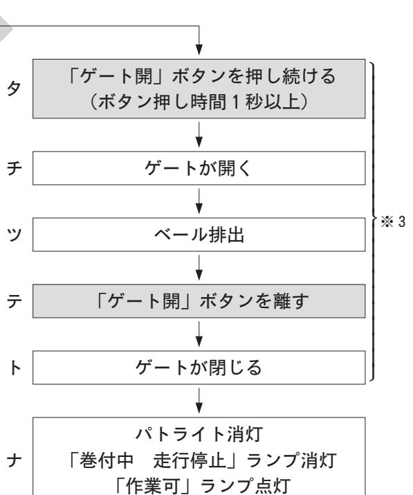
※5 「巻付中 走行禁止」ランプが点滅し、ブザーが鳴り（カンケツ音ピー、ピー、ピー、・・・）ゲートが自動で閉じる場合はベル排出不良を示しています。一度、電源ボタンを押して電源を切り、再度、電源を入れます。本機構のゲート開ボタンを押しゲートを開き、ストップバルブを閉じてゲートが閉まらない事を確認し、トラクタのPTO、エンジン、ソウサボックスの電源を切ります。その後、ロールベーラ内よりベルを引き出します。ベル排出後、ストップバルブを開きゲートを閉じ作業を始めてください。
