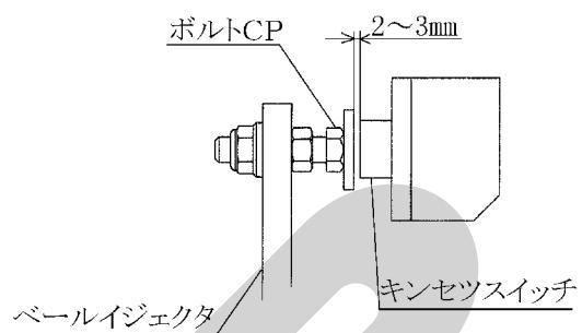
ベールイジェクタのボルトCPの高さを調整してキンセツスイッチとのすき間を2~3mmに調整してください。
