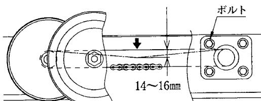
張りの強さはローラチェーンの中央部を指で押してたわみ量が14~16mmになるのが適正です。
