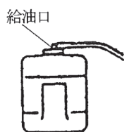
13. リザーブオイルタンク
