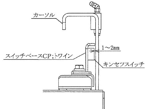
トワインバインディングのキンセツスイッチは、キンセツスイッチとカーソルのすき間を平行に 1~2mm になるようにスイッチベースC P ; トワインを位置調整します。
