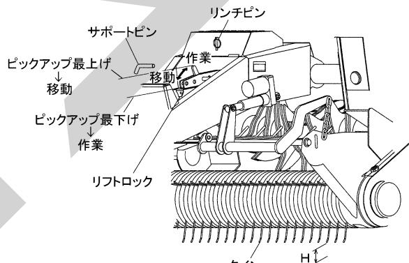
(2) リンチピンを外して、ゲージホイールを手前に引いて穴位置を変えて地上高Hを調整します。
