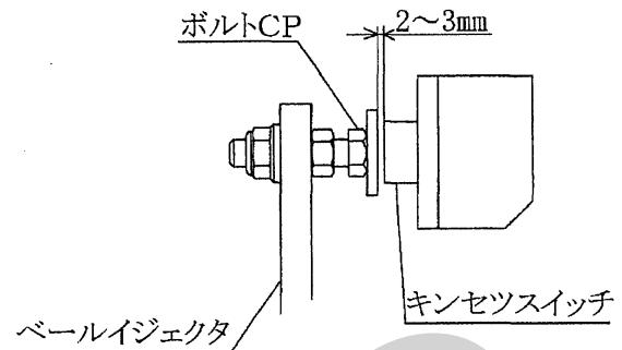
ペールイジェクタのボルトの高さを調節して、キンセツスイッチとのすき間を 2~3mm に調節してください。
