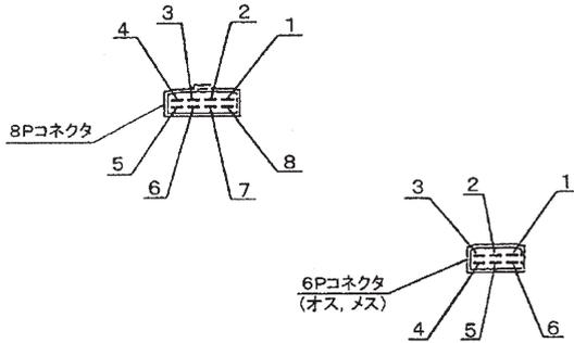
配線替えが必要な場合は、【配線一覧表】に基づき、配線の差し替えを行ってください。トラクタによっては一覧表と異なる場合があります。必ず動作確認を行ってください。また、トラクタ側に外部電装品取り出し口が装備されていない場合は、別途トラクタ側コネクタの電気配線が必要となります。
