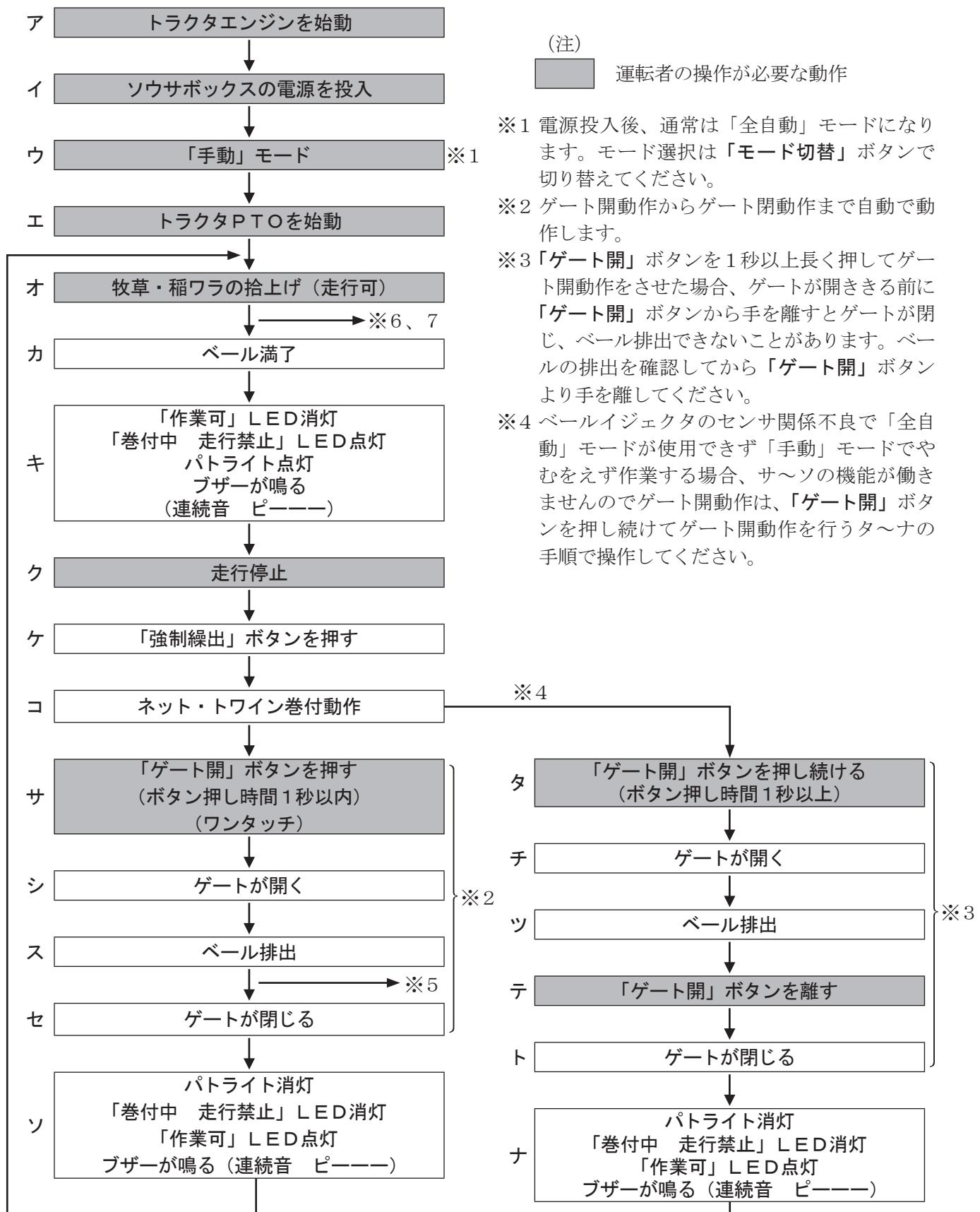
※5 表示部に番号「10」が点滅し、ブザーが鳴り（間欠音 長ピー、ピー、ピー、・・・）ゲートが自動で閉じる場合はベール排出不良を示しています。本機横の「ゲート開」ボタンを押しゲートを開き、トップバルブを閉じてゲートが閉まらない事を確認し、トラクタのPTO、エンジン、ソウサボックスの電源を切ります。その後、ロールベーラ内よりベールを引き出します。ベール排出後、トップバルブを開きゲートを閉じ作業を始めてください。
