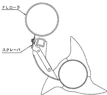
ロータスクレーパへの取り付けは下図の位置に取り付けてください。
