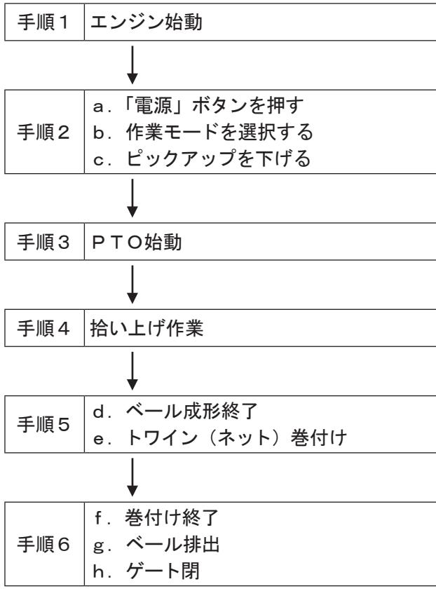
「手動」モードはトワイン・ネット巻付けからゲート開閉までの動作をソウサボックスで行なうモードです。
