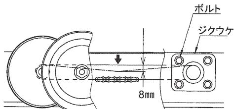
張りの強さはローラチェーンの中央部を5kgで押してたわみ量が8mmになるのが適正です。
