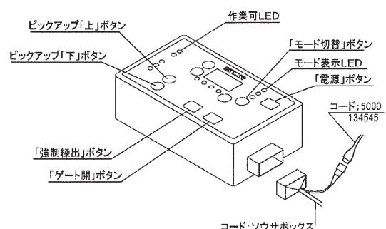
(4) ソウサボックスに取付けられているコード；ソウサボックスを接続してください。
