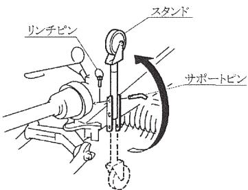
(7) 作業機の姿勢が水平になるように、トラクタロワーリングを調整してください。ロワーリングブラケット支点のピンの地上高が 460mm になるのが標準です。
