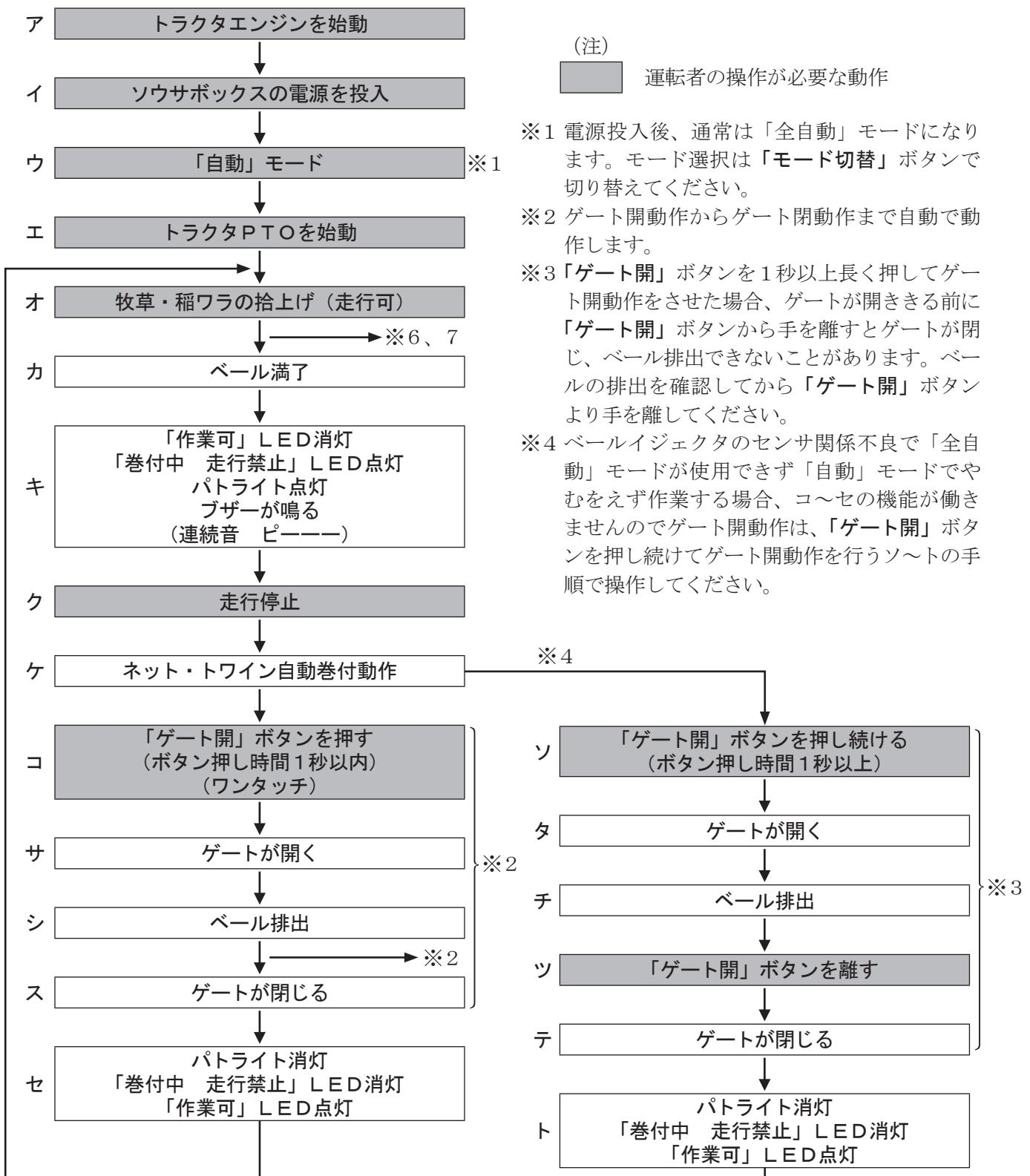
※5 表示部に番号「10」が点滅し、ブザーが鳴り（間欠音 長ピー、ピー、ピー、・・・）ゲートが自動で閉じる場合はベール排出不良を示しています。本機横の「ゲート開」ボタンを押しゲートを開き、ストップバルブを閉じてゲートが閉まらない事を確認し、トラクタのPTO、エンジン、ソウサボックスの電源を切ります。その後、ロールベーラ内よりベールを引き出します。ベール排出後、ストップバルブを開きゲートを閉じ作業を始めてください。
