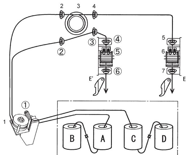
(5) トワインA、Cの始端部をバインディングナイフE・E'で切り、トワイン先端は、ナイフプレートに保持させてください。
