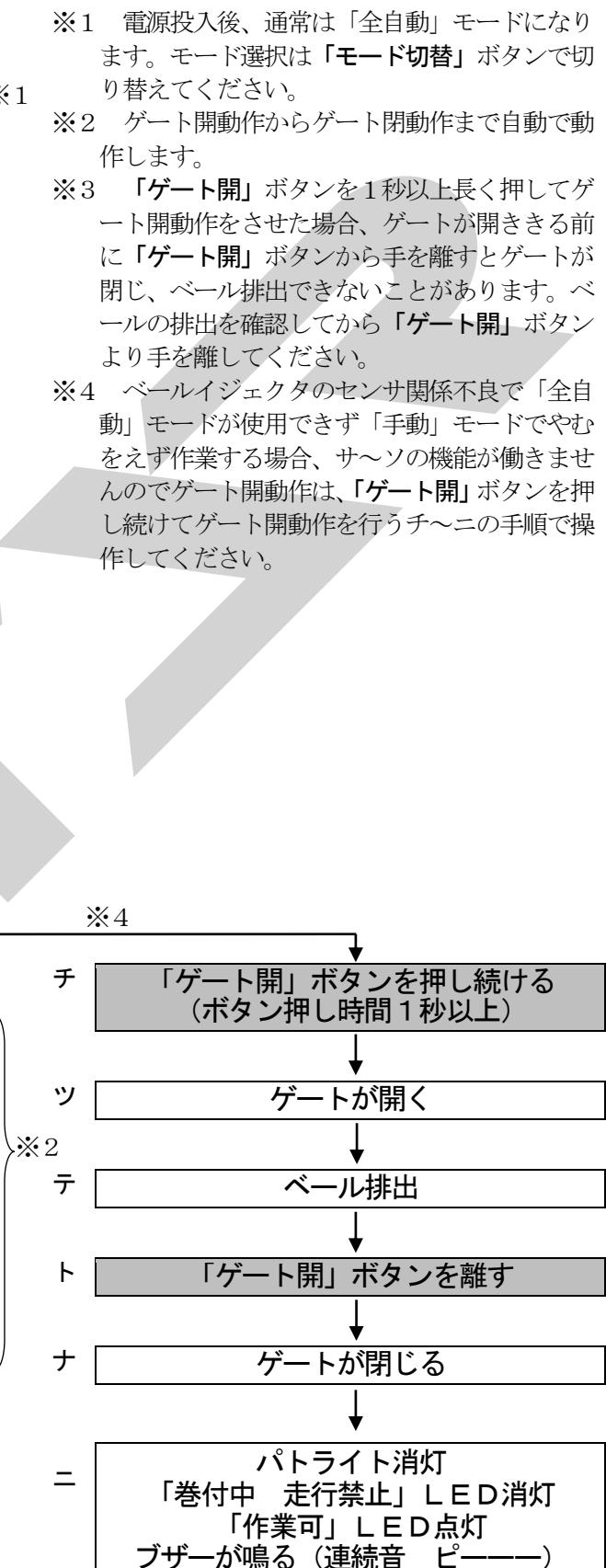
※5 表示部に番号「10」が点滅し、ブザーが鳴り（間欠音 長ピー、ピー、ピー、・・・）ゲートが自動で閉じる場合はベール排出不良を示しています。本機横の「ゲート開」ボタンを押しゲートを開き、ストップバルブを閉じてゲートが閉まらない事を確認し、トラクタのPTO、エンジン、ソウサボックスの電源を切ります。その後、ロールベーラ内よりベールを引き出します。ベール排出後、ストップバルブを開きゲートを閉じ作業を始めてください。
