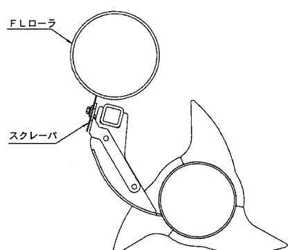
ロータスクレーパへの取り付けは下図の位置に取り付けてください。
