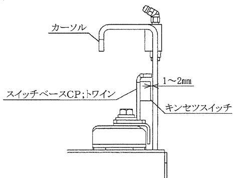
トワインバインディングのキンセツスイッチは、キンセツスイッチとカーソルのすき間を平行に1～2mmになるようにスイッチベースC P ; トワイン
