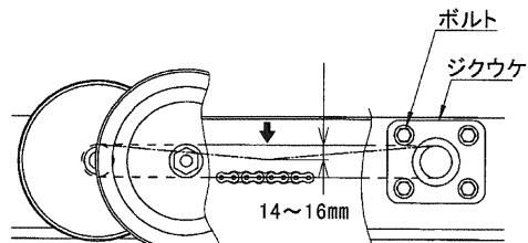
張りの強さはローラチエーンの中央部を指で押してたわみ量が14~16mmになるのが適正です。
