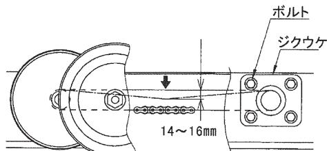
張りの強さはローラチェーンの中央部を指で押してたわみ量が14~16mmになるのが適正です。
