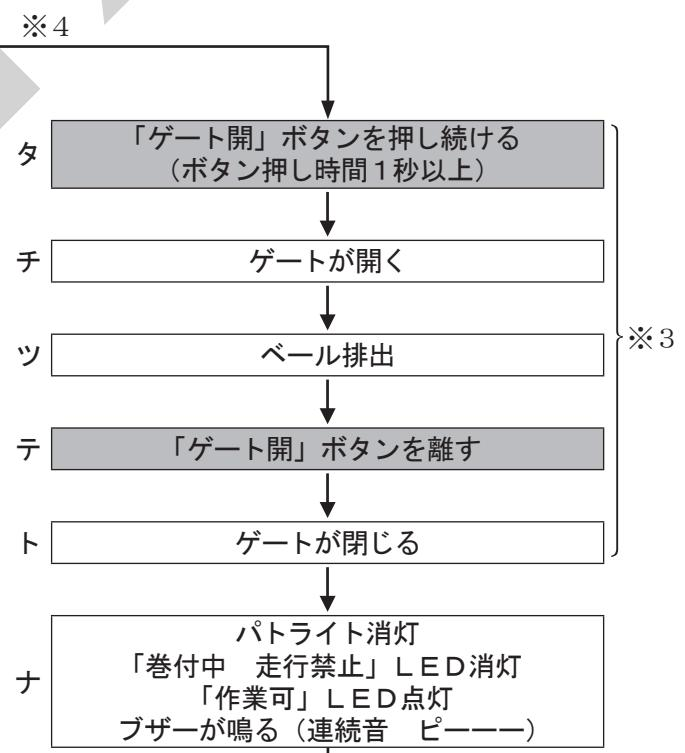
※5 表示部に番号「10」が点滅し、ブザーが鳴り（間欠音 長ピー、ピー、ピー、・・・）ゲートが自動で閉じる場合はベール排出不良を示しています。本機横の「ゲート開」ボタンを押しゲートを開き、ストップバルブを閉じてゲートが閉まらない事を確認し、トラクタのPTO、エンジン、ソウサボックスの電源を切ります。その後、ロールベーラ内よりベールを引き出します。ベール排出後、ストップバルブを開きゲートを閉じ作業を始めてください。
