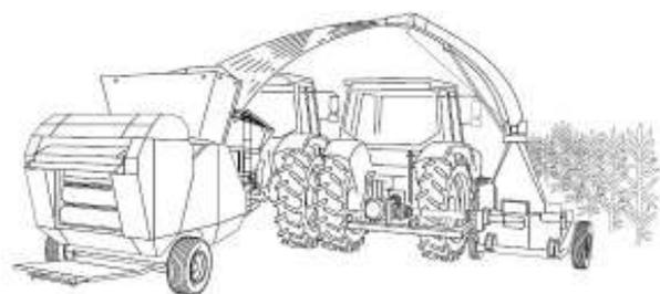
細断型ロールベアラ側のトラクタは、ハーベスタ側のトラクタの左やや後方につけて作業してください。
