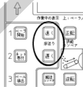
床送りコンベアの速度を0～5速の間で変更することが出来ます。
