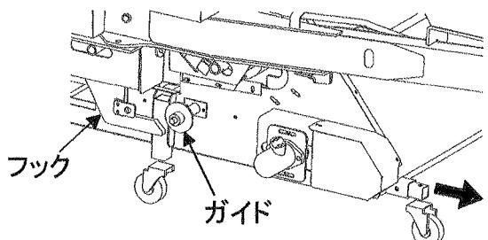
(8) 回収コンベアを引き抜ける高さまで本機を上げ（ローリングリンクブラケット支点で地面から約800～900mm）、回収コンベアを引き抜きます。
