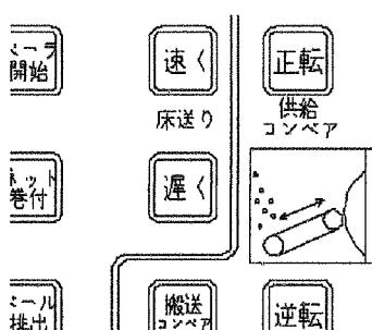
床送りコンベア、搬送コンベアは「停止」スイッチ押すと止める事ができます。
