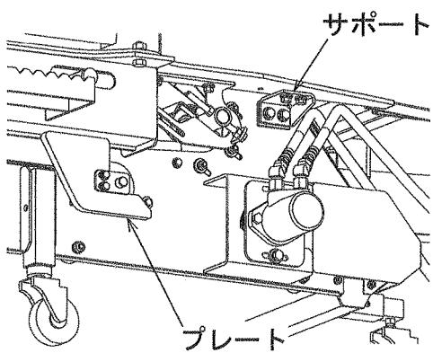
(5) ガイドがフックから外れるまで、回収コンベアを前方へ移動させます。
