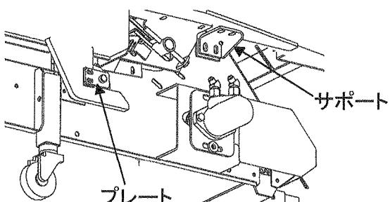
(6) (1) の作業を行った場合は、ガイドプレートをスライドさせ、供給コンベア従動軸に押し当た位置でナットを締めます。次に緩めた回収コンベアベルトの張り調整を行ってください。
