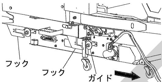
(6) 回収コンベアを引き抜ける高さまで本機を上げ（ロワーリングブラケット支点で地面から約800～900mm）、回収コンベアを引き抜きます。
