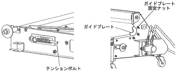
(5) 本機を水平にし、プレート（左右各2ヶ所）とサポート（左右各1ヶ所）で固定します。
