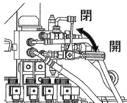
ゲートが下降する時は、オイル漏れ箇所を探し、補修または部品交換をしてください。
