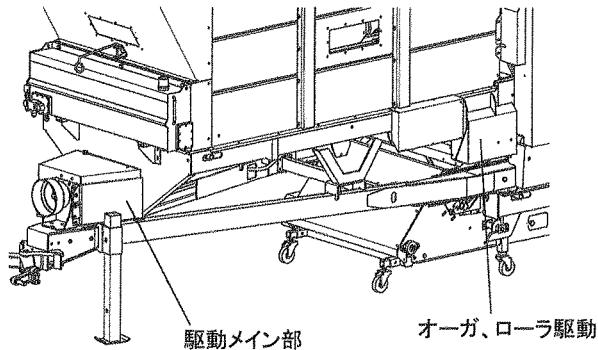
(2) 左右のコンベヤチェーンの持ち上がる量が同じになるように、左右のボルト（ゼンネジ）を締め込んでください。
