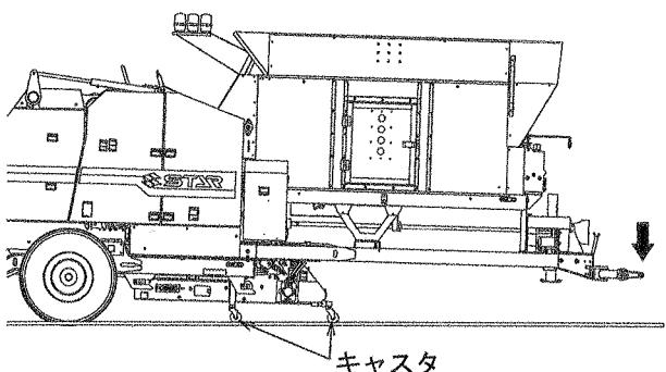
(4) 本機と回収コンベアを固定している、プレート（左右各2ヶ所）とサポート（左右各1ヶ所）のボルトを外します。
