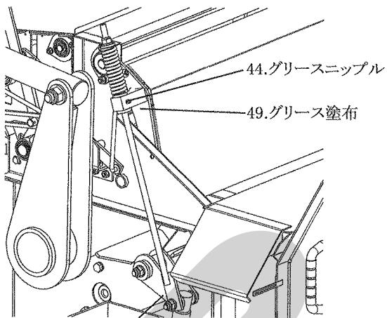
4.7. 回収コンベアバイピッチチェーン
