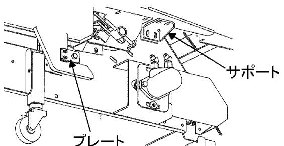
(6) (1) の作業を行った場合は、ガイドプレートをスライドさせ、供給コンベア従動軸に押し当たる位置でナットを締めます。次に緩めた回収コンベアベルトの張り調整を行ってください。
