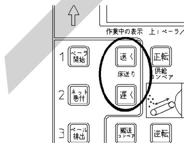
床送りコンベアの速度を0～5速の間で変更することが出来ます。
