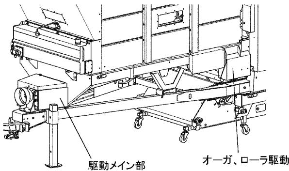
(2) 左右のコンベヤチェーンの持ち上がる量が同じになるように、左右のボルト（ゼンネジ）を締め込んでください。
