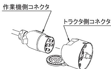
また、トラクタ側の外部電装品取出し口が6Pコネクタ（オスコネクタ、メスコネクタ）、8Pコネクタで装備されている場合は、**中間ハーネス(1172730000)**を使用して接続してください。
