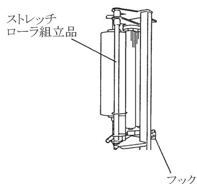
(5)フィルムは、巻き方向が上から見て反時計方向になるように挿入し、フィルムを引き出してください。
