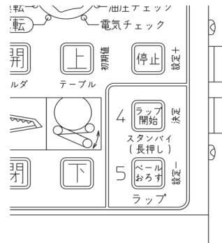
(5) 操作ボックスの設定選択ダイヤルを「油圧チェック」に合わせます。
