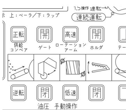
(7) ゲートが上限まで上昇したら「ゲート開」スイッチから手を離し、ストップバルブを「閉」側に切替えます。
