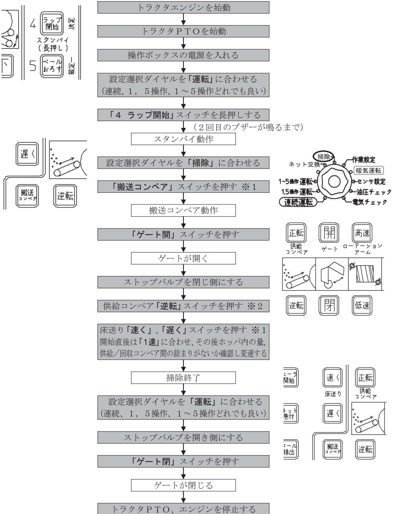
※1 床送りコンベア、搬送コンベアは「停止」スイッチを押すととめる事ができます。
