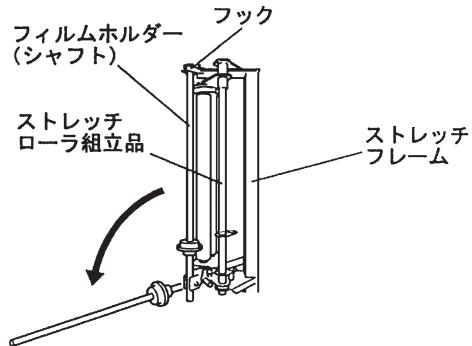
(3)フィルムホルダー（シャフト）より、ベータピン・ローラを抜き取りフィルムを挿入します。フィルム挿入後、ローラ・ベータピンを挿入し、上方に押し上げ、フィルムホルダー（シャフト）上部でストレッチフレーム上部フックと固定します。（ベータピン挿入方向に注意してください。）
