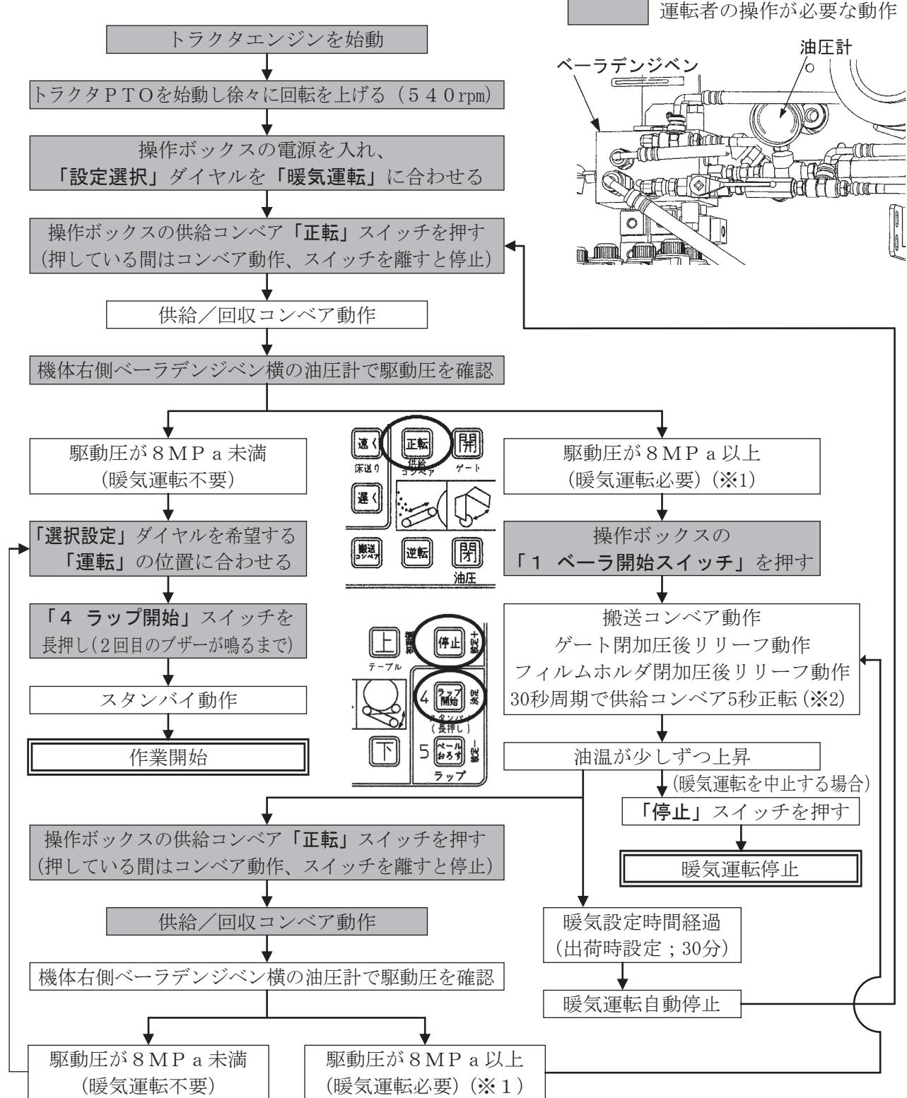
※1 油温が上がっていても圧が下がる傾向がない場合は、供給コンベアベルト従動側ローラスクレーパ部にゴミが詰まっている、バイピッチチェーンへの注油不足などの可能性があります。ゴミを除去しバイピッチチェーンに注油後、供給/回収コンベア正逆転を何度も繰り返し、再度駆動圧を確認してください。(設定選択ダイヤルが暖気運転の場合、供給/回収コンベア逆転操作は受け付けません。ダイヤルをいずれかの運転に合わせて行ってください。)
