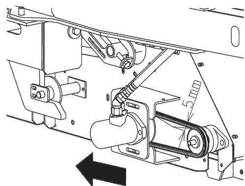
5. ネット駆動Vベルトのストップと張り調整
