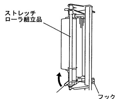
(2) フィルムホルダー（シャフト）をストレッチフレーム上部フック部より外し、手前側に倒します。
