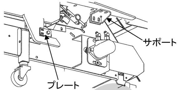
(6) (1)の作業を行った場合は、ガイドプレートをスライドさせ、供給コンベア従動軸に押し当てた位置でナットを締めます。次に緩めた回収コンベアベルトの張り調整を行ってください。
