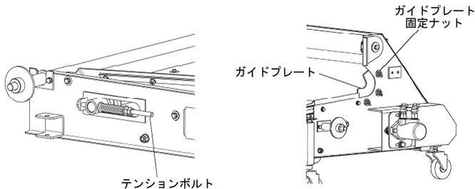
(2) 回収コンベアを挿入できる高さまで本機を上げ（ローリンクブラケット支点で地面から約800～900mm）、回収コンベアを本機供給コンベア前方まで移動してください。
