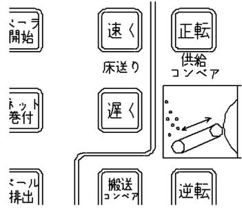
※1 床送りコンベア、搬送コンベアは「停止」スイッチを押すと止める事ができます。
