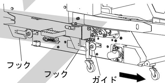
(6) 回収コンベアを引き抜ける高さまで本機を上げ（ローリンクブラケット支点で地面から約800～900mm）、回収コンベアを引き抜きます。
