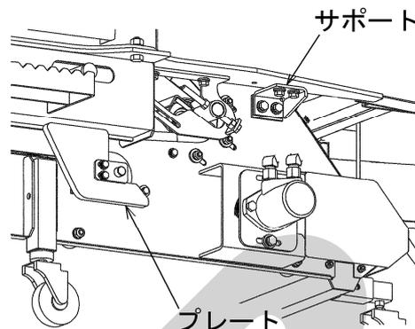
(5) ガイドがフックから外れるまで、回収コンベアを前方へ移動させます。
