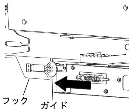
(5) 本機を水平にし、プレート（左右各2ヶ所）とサポート（左右各1ヶ所）で固定します。
