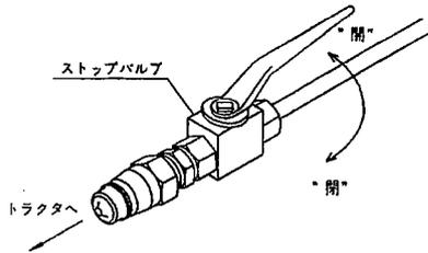
(2) 本作業機のブレーキは油圧仕様となっています。ブレーキ用カプラをトラクタのトレーラブレーキ取出口に接続してください。
