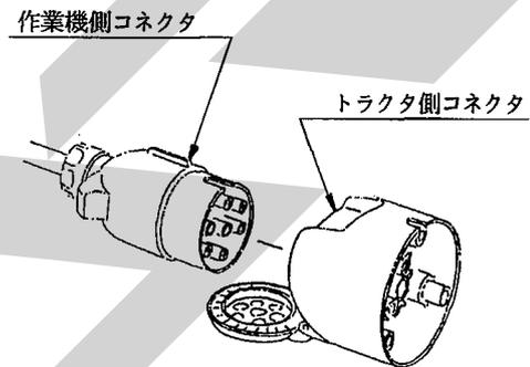
トラクタ側の外部電装品取り出しが装備されていない場合、別途電気配線が必要となります。
