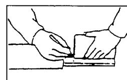
(3) パイプのアウタ・インナ両方を金ノコまたはカッターで切断します。
