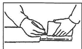
(3) パイプのアウタとインナ両方を金ノコまたはカッターで切断します。切断する時は、パイプの中にウエスを詰め、パイプ内面に切り粉が付着するのを防いでください。
