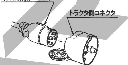
トラクタ側に外部電装品取り出し口が装備されていない場合は、別途電気配線が必要となります。
