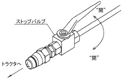
(2) 本作業機のブレーキは油圧仕様となっています。ブレーキ用カプラをトラクタのトレーラブレーキ取り出し口に接続してください。
