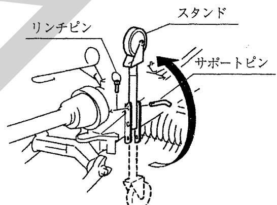
(7) 作業機の姿勢が水平になるように、トラクタロワーリンクを調整してください。ロワーリンクブラケット支点のピンの地上高が460mmになるのが標準です。
