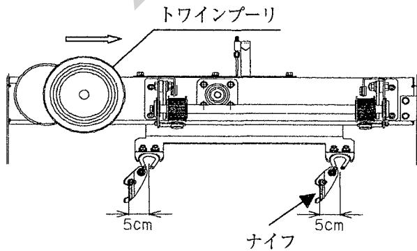
(4) トワインAの始端部を1～10の順序でトワインCの始端部を①～⑨の順序で通します。
