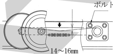
張りの強さはローラーチェーンの中央部を指で押してたわみ量が14~16mmになるのが適正です。
