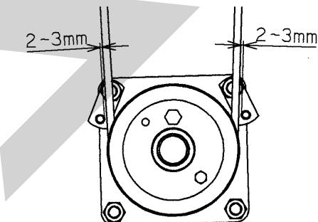
(2) トワイン・ネットを繰出すテンションクラッチのVベルトがすべる場合は、Vベルトの張り量を調整してください。
