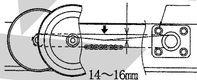
張りの強さはローラチェーンの中央部を指で押してたわみ量が14~16mmになるのが適正です。
