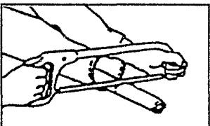
(4) 切り口をヤスリなどでなめらかに仕上げてからパイプをよく清掃し、次にグリースを塗布して、アウタとインナを組み合わせます。
