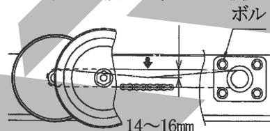
張りの強さはローラチェーンの中央部を指で押してたわみ量が14~16mmになるのが適正です。
