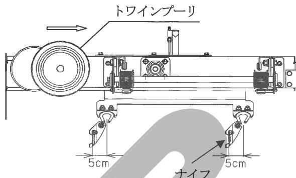
(4) トワインAの始端部を①～⑩の順序でトワインCの始端部を①～⑨の順序で通します。
