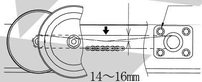
張りの強さはローラーチェーンの中央部を指で押してたわみ量が14~16 mmになるのが適正です。
